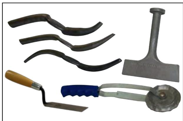
Quelques outils de finition pour Béton Imprimé
